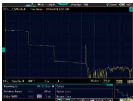
使用高SNR (HSN) 模式测量128端口分路器的示例
